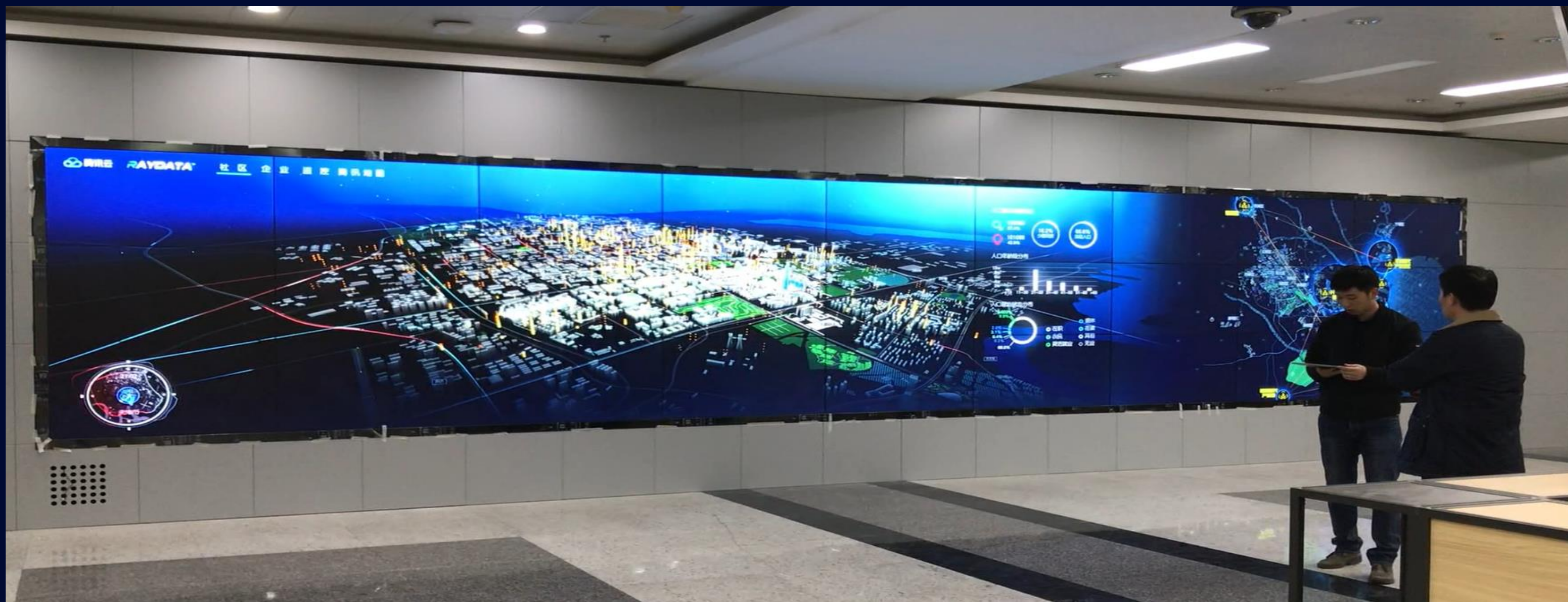
现场布设图：3*9巨型拼接屏，共11米*2米；平板电脑无线交互操作体验
