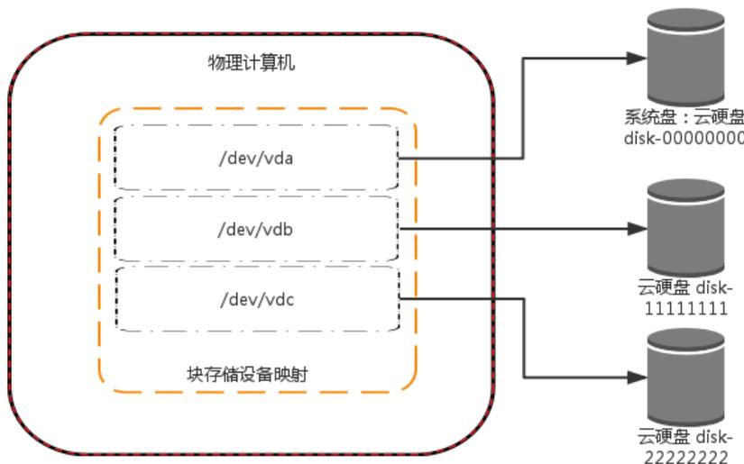
此图显示了 CBS 如何将块存储设备映射到云服务器上：将 /dev/vda 映射到系统盘上，并将两块数据盘分别映射到 /dev/vdb 和 /dev/vdc。云服务器实例会自动为挂载至其的本地盘及云硬盘创建块存储设备映射。
