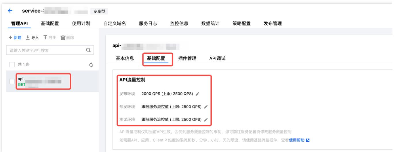
4. 默认每个 API 的流控值，跟随服务流控值。如果需要单独设置，则单击编辑图标，将弹出下列提示框，按需修改即可。
