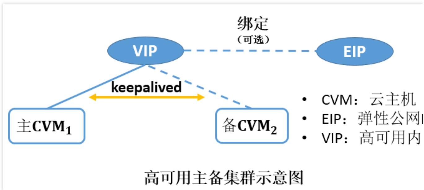
在传统的物理网络中，可以通过 keepalived 的 VRRP 协议协商主备状态，其原理是：主设备周期性发送免费 ARP 报文刷新上联交换机的 MAC 表或终端 ARP 表，触发 VIP 迁移到主设备上。
