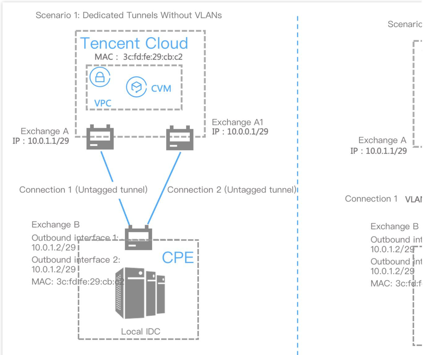
图中用户侧交换机 B 通过两条专线（专线1和专线2）连接腾讯云，分别与腾讯云侧交换机 A 和交换机 A1 相连。腾讯云返回给用户 IDC 的报文在交换机 B 处发生 MAC 地址漂移。
