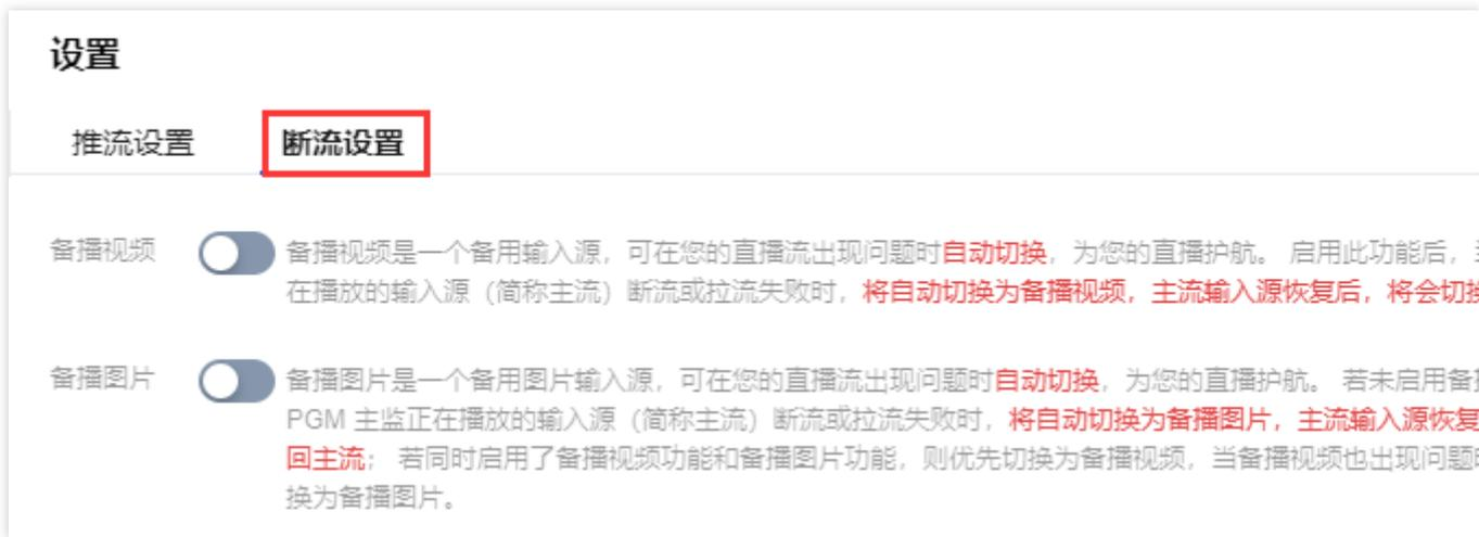
2. 可选择是否开启备播视频。备播视频是一个备用输入源，启用此功能后，当 PGM 主监正在播放的输入源断流或拉流失败时，将自动切换为备播视频，主流输入源恢复后，将会切换回主流。
