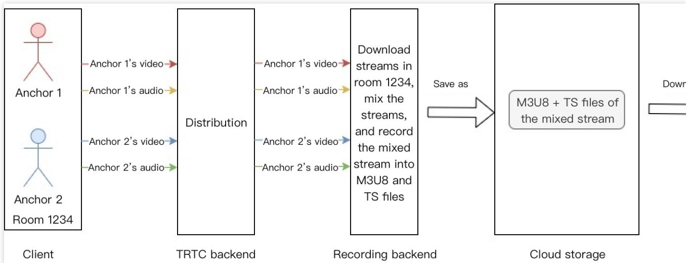
如图所示为混流录制的场景，房间1234里面有主播1和主播2都上行了音视频流，假设您订阅了主播1和主播2的音视频流，设置录制模式为混流录制，录制后台会分别拉取主播1和主播2的音视频流，并把他们的视频流按照您配置多画面模板进行混流，音频流进行混音，最后把媒体流混合成一路媒体文件，包含：
