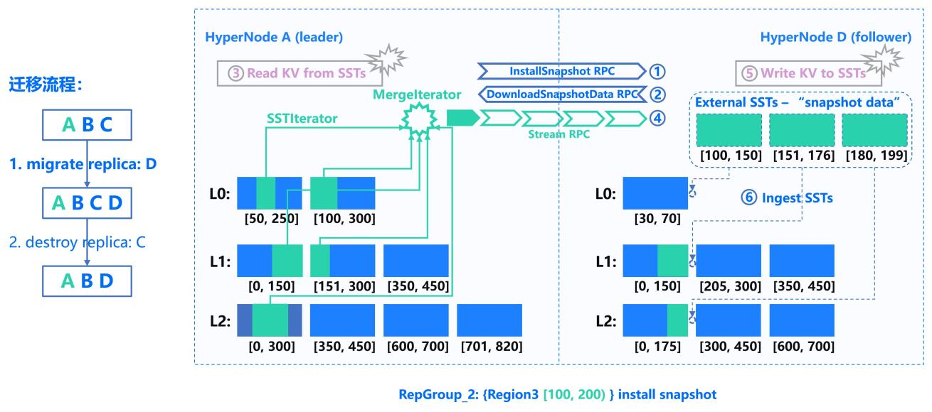
1. **数据提取阶段:** 从 Leader 的 LSM-Tree 中遍历提取特定 key range 的数据。数据可能分散在不同层级、多个 SST 文件；需要逐条扫描和筛选，IO 开销大。
