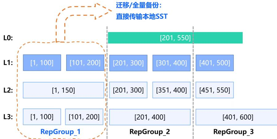
在底层数据压缩 ( compaction ) 过程中，增加对 SST 文件和数据分片 Region 边界对齐的逻辑处理。
