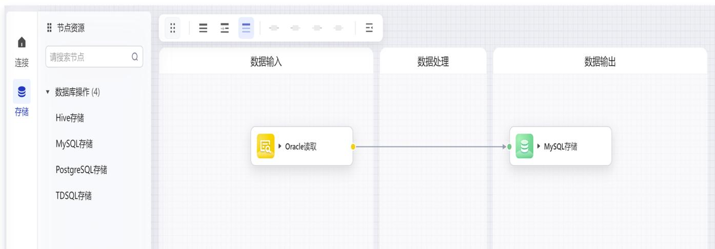
6. 拖入画布后，在画布栏中单击选中**节点**，配置节点的详细参数。配置 Oracle 读取节点的连接器、同步的数据库表、字段。
