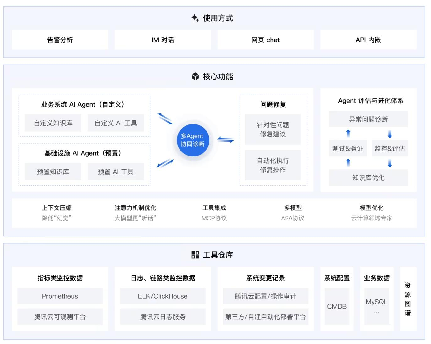
Cloud Mate 智能运维 AI Agent 采用分层解耦架构，由核心功能与工具仓库组成，通过多 Agent 协同诊断机制实现系统异常问题根因分析、知识沉淀与自动修复闭环：
