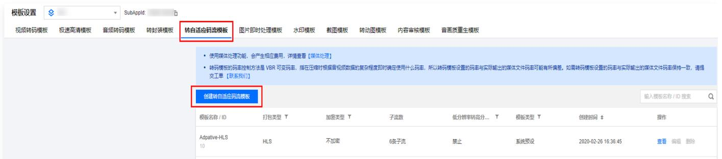
通过模板创建用户需要的自适应码流，本文创建一条名为 testAdaptive 的自适应码流模板，总共包含三条子流，分辨率分别为 480p，720p和1080p。视频码率、视频帧率、音频码率则保持与原视频一致。
