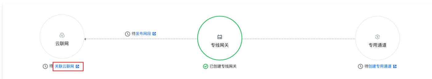
成功添加云联网实例后，云联网图标将显示已关联且图标颜色显示为绿色，专线网关与云联网之间的虚线变为实线。即专线网关与云联网已互联。
